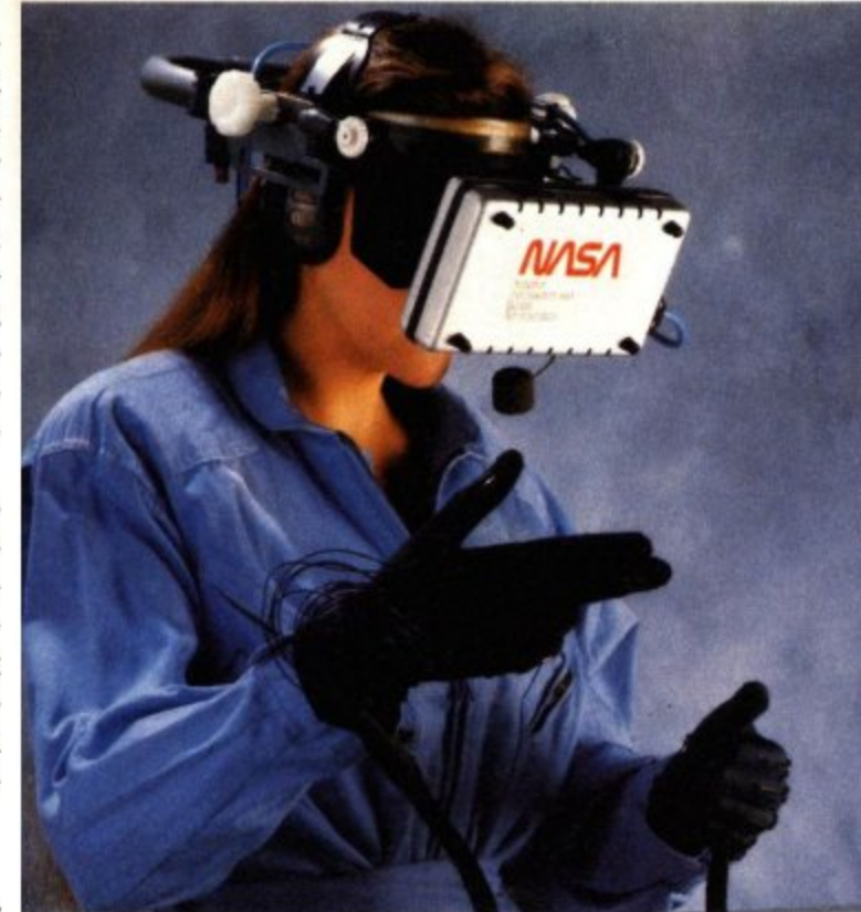
NASAN VIEW-järjestelmä luo käyttäjän ympärille keinotodellisuuden. Kanssakäymisen keinotodellisuuden kanssa tapabtu puhumalla ja liikuttamalla raajoja.
