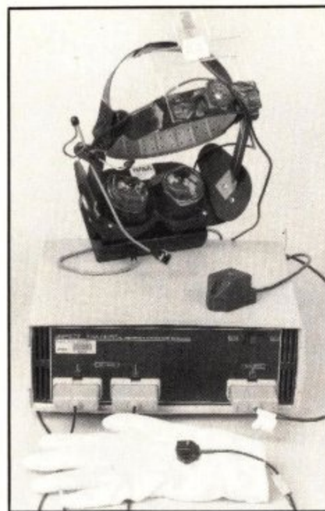
NASAN VIEW-järjestelmä luo käyttäjän ympärille keinotodellisuuden. Kanssakäymisen keinotodellisuuden kanssa tapabtu puhumalla ja liikuttamalla raajoja.
