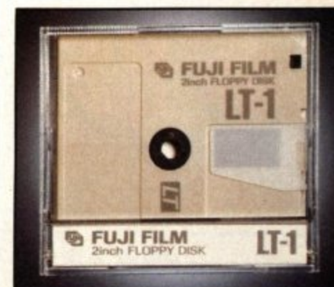
Fujin kahden tuuman mini-levykkeelle mahtuu megatavu tietoa.
